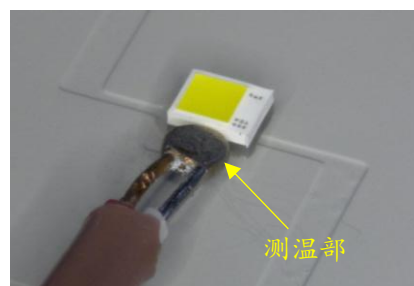
热电偶丝径大、测温部形状过大
